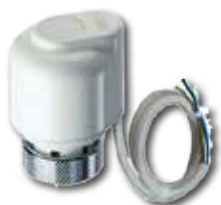
Elektrisk aktuator 24V Normalt stengt Åpne-/lukketid 180 sek.
