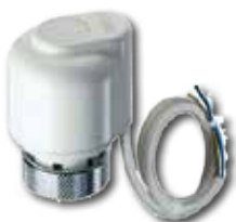
Elektrisk aktuator 230V Normalt stengt Åpne-/lukketid 180 sek.
