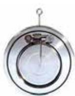
Klaff tilbakeslagsventil Med fjær AISI 316/EPDM
