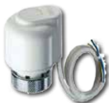
Elektrisk aktuator 24V Normalt åpen Åpne-/lukketid 180 sek.
