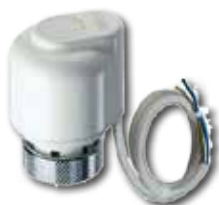
Elektrisk aktuator 24V Normalt stengt Åpne-/lukketid 180 sek.
