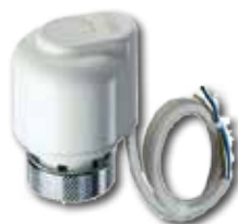
Elektrisk aktuator 230V Normalt åpen Åpne-/lukketid 180 sek.
