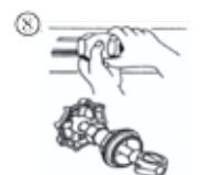
8 Fjern dekslet i trange arbeidsrom for lettere installasjon.
