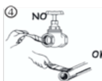
4 Fordel gjengetetting kun på rørgjengene, ikke på sluseventilens gjenger.
