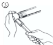
3 Fjern spon fra rørendene etter gjenging. Spon kan forhindre tetting.
