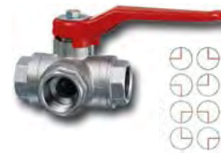
3-veis kuleventil Messing, L-løp, innv. gjenger
