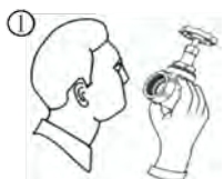
1 Inspiser sluseventilens gjenger for smuss før installasjon. Smuss kan skade ventilsetene og forårsake lekkasjer.
