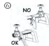
6 For å forhindre forvrenning og skade på bevegelige deler, sett ikke sluseventiler i skrustikke på arbeidsbenk. Sett heller røret i skrustikke og skru sluseventilen på plass.
