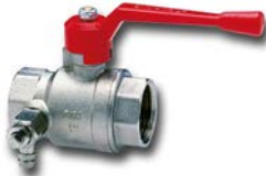
Kuleventil, innv. gjenger 1/4" avtapping, messing
