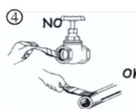
4 Fordel gjengetetting kun på rørgjengene, ikke på sluseventilens gjenger.
