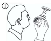
1 Inspisere sluseventilens gjenger for smuss før installasjon. Smuss kan skade ventilsetene og forårsake lekkasjer.
