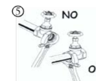
5 Ved montering, bruk skiftenøkkel, ikke rørtang, og bruk kun nødvendig vridningsmoment og kun på rørenden av sluseventilen. Dette gir et fastere grep og unngår potensiell skade på sluseventilens hus.
