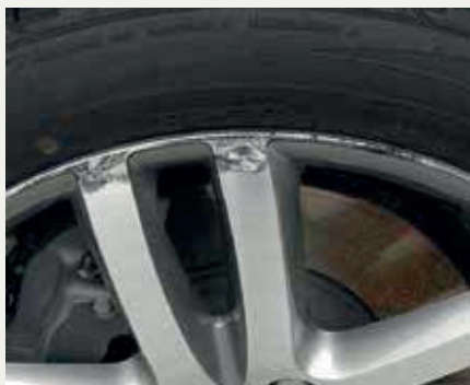
Materialabtragung an der Felge
