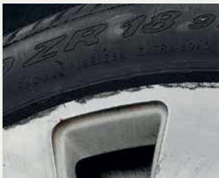
Beschädigung Felgenhorn mit Materialabtragung
