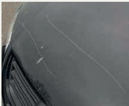
Beschädigung des Basislackes
