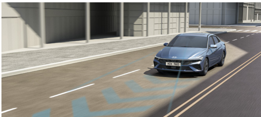
מערכת סיוע לשמירה על מרכז נתיב הנסיעה (LFA) מערכת אקטיבית המסייעת בשמירה על מרכז נתיב הנסיעה.
