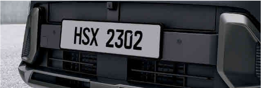
כונסי אוויר אקטיביים כונסי האוויר האקטיביים העליונים והתחתונים שבגריל הקדמי מפחיתים את זרם האוויר המיותר כדי לצמצם למינימום את התנגדות האוויר וכדי לשפר את תצרוכת הדלק.
