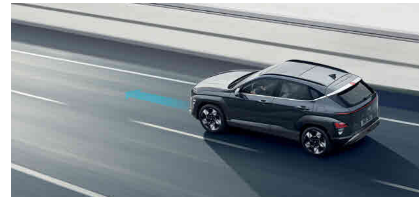
מערכת סיוע לשמירה על מרכז נתיב הנסיעה (LFA) מערכת אקטיבית המסייעת בשמירה על מרכז נתיב הנסיעה.
