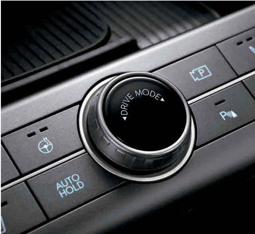
Drive Mode - בורר מצבי נהיגה בכביש בחירה מבין מגוון מצבי נהיגה על בסיס העדפותיך האישיות או תנאי הדרך. המנוע ומערכת הבלמים מכילים לביצועים אופטימליים, בהתאם למצב שנבחר ולתנאי הדרך.
