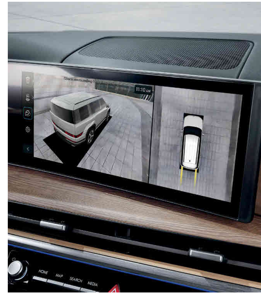
מערכת מצלמות היקפיות - שילוב תמונות מארבע מצלמות רחבות זווית. המערכת מאפשרת תצוגת 360° בתלת-ממד ומשדרת את תמונת סביבת הרכב ישירות למסך*.
