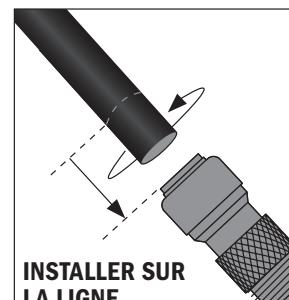
**AVERTISSEMENT :** Ne pas ébavurer correctement l'intérieur et l'extérieur du tube peut endommager le joint torique du produit.
