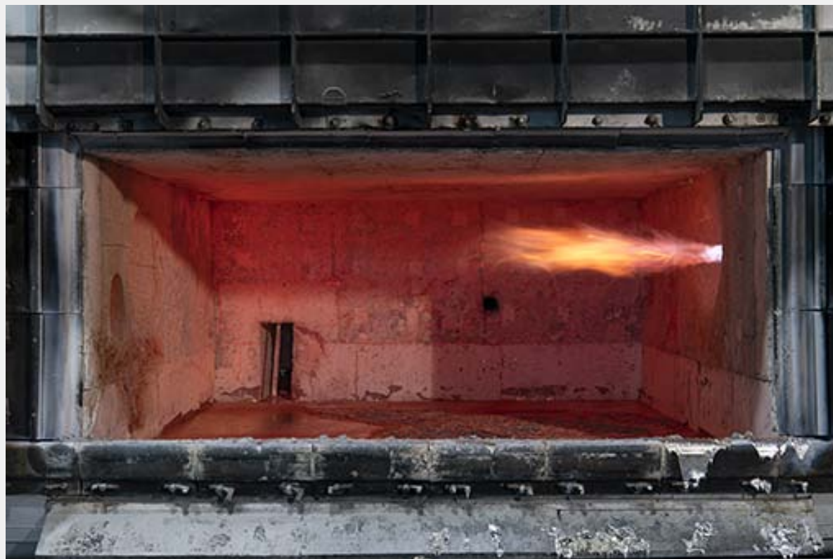
C-TEC, France - juillet 2024 Première production industrielle réussie d'une plaque d'aluminium par combustion d'hydrogène et d'oxygène
