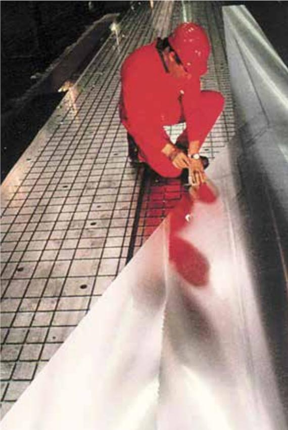
Contrôle d'une ébauche d'aile d'Airbus pouvant atteindre 22 m de longueur
