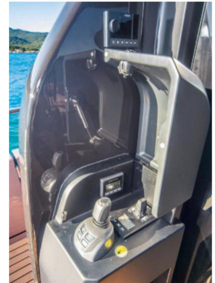
Ein Joystick und der Bedienhebel des Bugstrahlruders am Steuerstand in der Plicht erlauben das entspannte Anlegemanöver mit guter Sicht auf die Umgebung.
