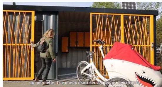
La configuration de mobilipod retenue pour ce projet permet de stocker deux triporteurs d'un côté, de 6 à 12 vélos (si avec rack sur 2 niveaux) de l'autre côté. Il propose aussi des outils de réparation retenus par câble et un compresseur électrique. Il est éclairé par LEDs et raccordable au réseau électrique par une prise Hypra.
