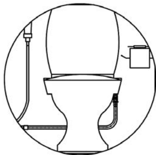
WC-istuimen kytkentä Uponor-kytkentäliitin 16 x 10 (1070705)
