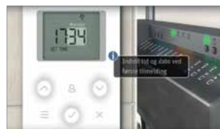
3. Aseta kellonaika ja päivämäärä. Tämä sinun tarvitsee tehdä vain yhdessä järjestelmän huonetermostaateista.
