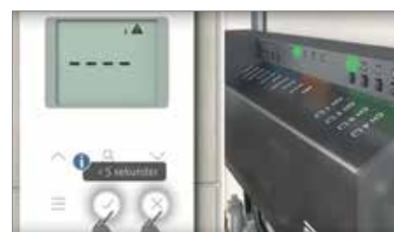
2. Vain kaksi painallusta: valitse ensin ohjausyksikön kanava ja aktivoi sitten huonetermostaatti.
