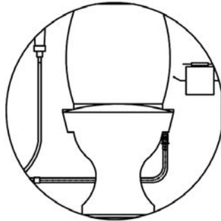
WC-istuimen kytkentä Uponor-kytkentäliitin 16 x 10 (1070705)
