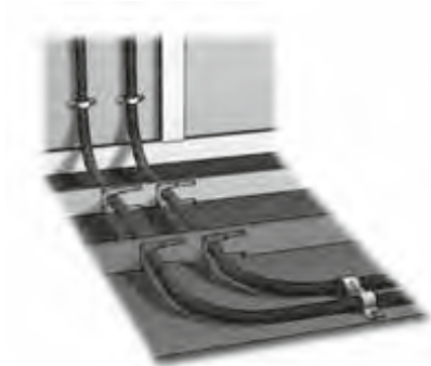
Esimerkki putkien sijoittamisesta välipohjan koolautilaan
