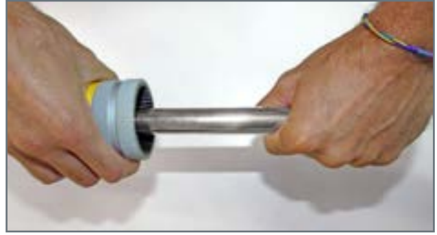
2. Poista jäysteet/terävät reunat putken sisä-/ulkopuolelta.
