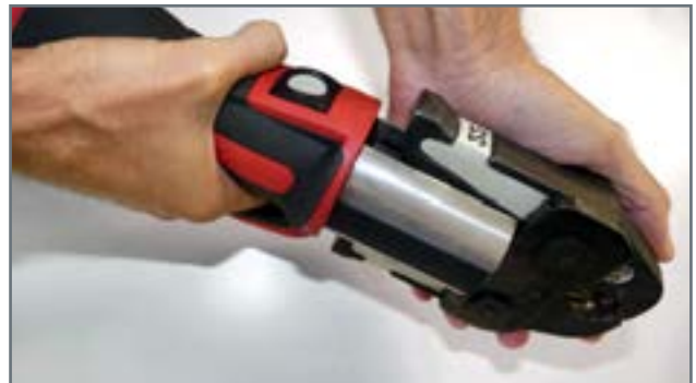
6. Puristusleuan asennus: Puristuskoneen päästä vedetään lukitustappi ulos ja asennetaan väliin oikeankokoinen leuka. Kun tapin lukitsee takaisin, on kone käyttövalmis.
