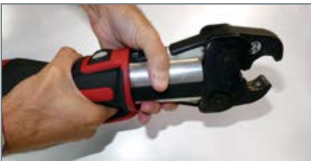
7. Avaa puristusleuat, aseta ne osan ympärille.
