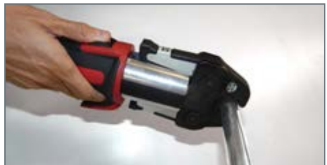
8. Aloita painaminen, leukojen on sulkeuduttava täysin. Kun liitos on valmis, puristuksen lopussa kuuluu naksahdus.
