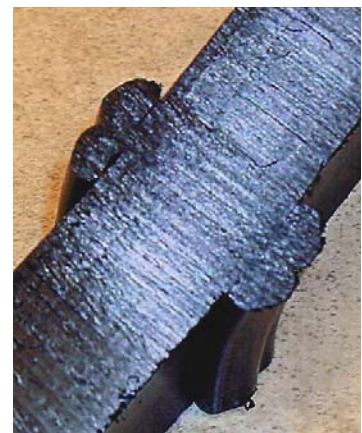
Hitsauspurseita PE putkessa, puskuhitisausliitoksen poikkileikkaus
