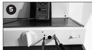
5 Mittaa jännite navoista – ja S, säädä nopeus 2 potensio- metriä 2, jne.
