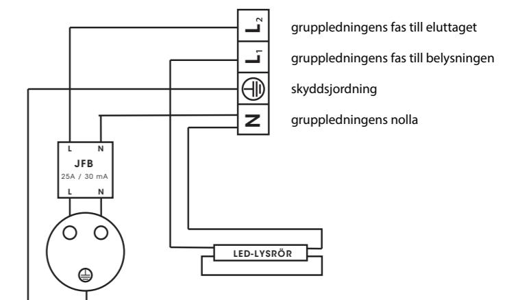
Följande tekniska tilläggsinformation ska beaktas vid installation eller byte av LED-lysrör:
