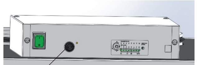
Yliämpösuojan kuittaus- painike
