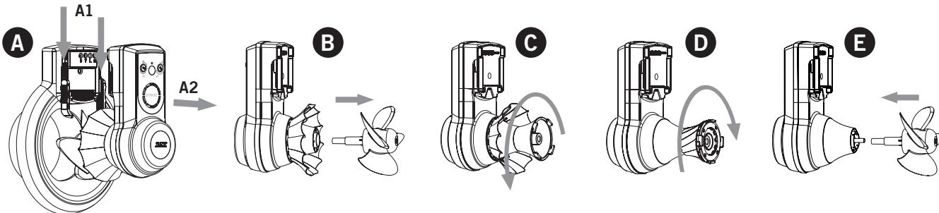
Lyft motorenhet ur ramstycket (se fig A) genom att först skjuta de båda låsknapparna mot centrum (A1). Tag därefter loss motorenheten (A2).
