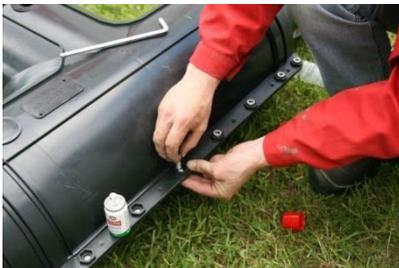
8. FI Kiinnitä rungot kiinni toisiinsa mukana tulleilla ruuveilla.
