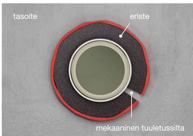
Kuva 41: Mekaaninen tärinänlöpäisy viallisen putkieristyksen kautta.
