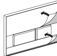
**2** Introduzir a placa de inserção na moldura da placa de comando
