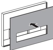
**2** Verificar o funcionamento das teclas de comando. As teclas não devem tocar na placa de inserção
