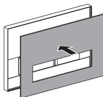
**2** Vérifier le fonctionnement des touches. Les touches ne doivent pas frotter sur la plaque d'insertion
