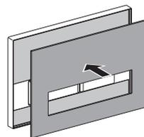
**i** Ne pas confondre surface visible (B) et surface adhésive (D).
