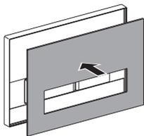
**2** Проверете функционирането на бутоните. Бутоните не бива да докосват основата
