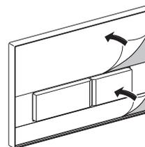
**2** Vložte vkladací kryt do obslužného panelu
