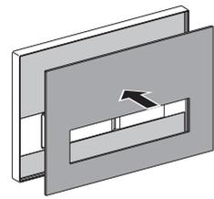
**i** Ne zamenjajte vidne površine (B) in površine lepljenja (D).
