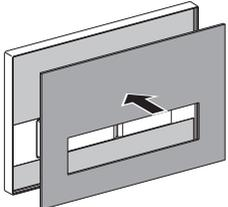
**i** Non scambiare la superficie in vista (B) e la superficie adesiva (D).
