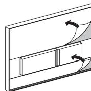
**2** Placer la plaque d'insertion dans le cadre de la plaque de déclenchement
