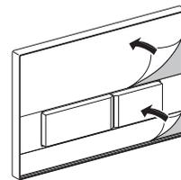
**2** Inlegplaat in omranding van de bedieningsplaat leggen
