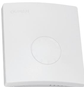
Huoneanturi (TMR) sijoitetaan noin 150cm:n korkeudelle paikkaan, jossa se mittaa huoneiston keskimääräistä lämpötilaa. Huoneanturia ei saa asentaa auringonpaisteeseen eikä lämmönlähteen lähelle. Huoneanturi voidaan asentaa seinään tai kojerasian päälle. Tätä huoneanturia voidaan käyttää myös huonelämpötilan keskiarvomittauksessa. Keskiarvomittaus otetaan käyttöön J1-oikosulkupalalla.
