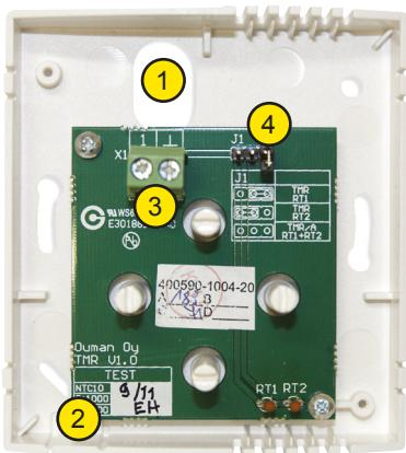
Комнатный датчик можно установить прямо на стену или на обычную розеточную коробку. На дне коробки датчика имеются отверстия как для настенного крепления, так и для розеточной коробки.
