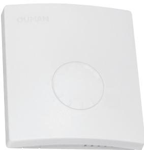
Комнатный датчик TMR устанавливается на отметке около 150 см в месте, где будет производиться измерение среднего значения температуры воздуха в помещении. Запрещается установка комнатного датчика под прямые солнечные лучи или вблизи источников тепла.
