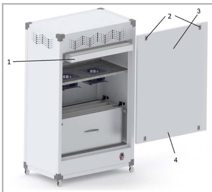
Kuva 9-1 Esisuodattimien vaihtaminen ilmanpuhdistimiin AP BIO 400, AP BIO 500 ja AP BIO 1000
