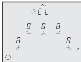
Neste momento, a placa está ligada mas todas as zonas de cozimento e o exaustor estão a zero de potência. A Placa desliga-se automaticamente ao fim de 20 segundos, se não for utilizada.
