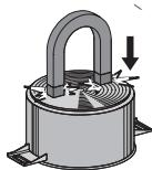
**Atenção:** utilize exclusivamente tachos com fundo perfeitamente plano e adequado para zonas de cozedura por indução. A utilização de tachos com fundo irregular pode prejudicar a eficiência do sistema de radiação de calor e entravar a deteção da presença de tacho na zona de cozedura.
