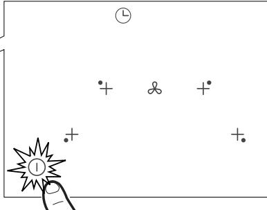
Tryck på PÅ/AV-knappen ① i 2 sekunder för att slå på och aktivera spishällens funktioner. Samtliga teckenrutor visar  $\text{B}$ . och de för timern "C L".
