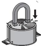
**Advarsel:** brug kun gryder med perfekt flad bund og egnede til induktionskogezone. Brug af gryder med en ujævn bund kan påvirke varmestrålningssystemets effektivitet og hindre detekteringen af kogegreb på en kogezone.
