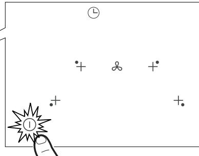
Trykk på på/av-knappen ① i 2 sekunder for å slå på platetoppen og aktivere platetoppens funksjoner. Alle nummervisningene viser 0. og de til timeren viser " C L ".
