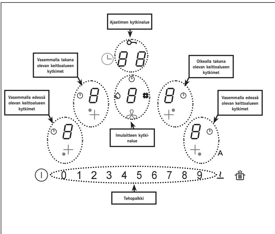
Keittoalueiden, imulaiteen ja ajastimen kytkinalueet voidaan aktivoida painamalla viitettä **B**. Numeronäytön sytyminen kirkkaaksi vahvistaa sen.
