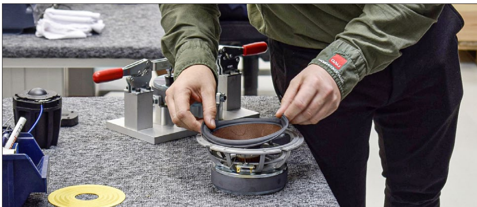
Fast alles wird im eigenen Werk entwickelt und nach strengen Vorgaben gefertigt: Hier wird die Bassmembran in den Gusskorb geklebt, was extreme Sorgfalt erfordert.
