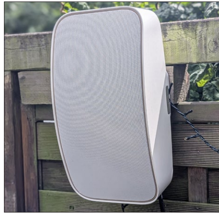
Die Montage kann quer, hochkant oder auch schräg erfolgen, ohne den Halter zu verändern.
