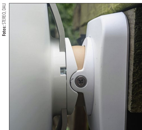
Die unscheinbare Klinke links der Schraube arretiert den Speaker auf dem Halter.
