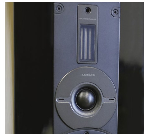
Der vermeintlich bekannte Hybrid-Hochtöner kommt jetzt ohne Ferrofluid-Kühlung aus.
