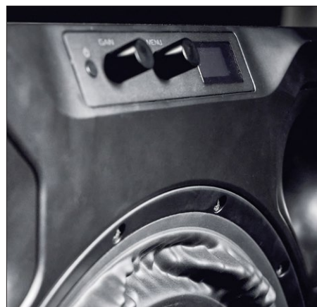
Das frontale Bedienpanel umfasst ein kleines Display und zwei Knöpfe.
