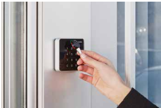
Berechtigungsprüfung mittels Smartkey und Leser
