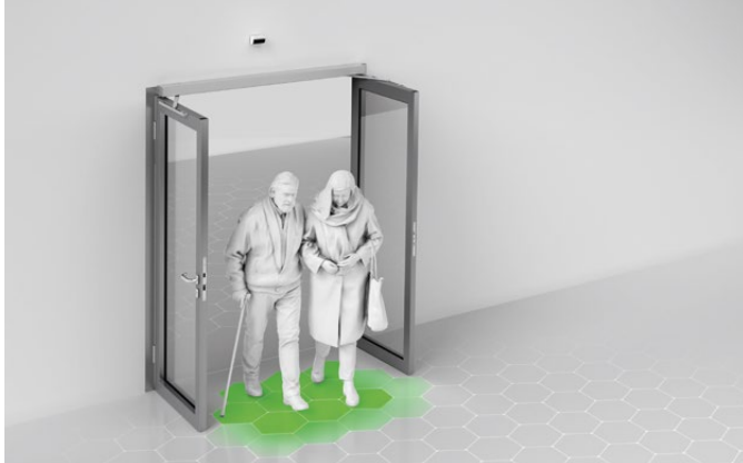
Lång öppethållandetid med långsam passering. Dörren förblir öppen tillräckligt länge för att personerna ska kunna passera
