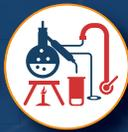
Separa componentes de um ou mais líquidos miscíveis que são vaporizados e posteriormente separados em uma coluna de fracionamento antes de serem condensados. Exemplo: obter subprodutos do petróleo.
