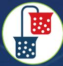
Líquidos sobrenadantes a sólidos sedimentados são separados por diferença de escoamento ou com uso de uma mangueira. Exemplo: sifão.
