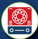
Com o uso de uma centrífuga, as partículas mais densas ficam sedimentadas no fundo do tubo de centrifugação. Exemplo: separar plasma de hemácias.
