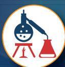
Separa os componentes de uma mistura formada por sólido dissolvido em um líquido. O líquido é vaporizado, em seguida condensado e recolhido em um frasco coletor. Exemplo: separar água de sais minerais formando água destilada.
