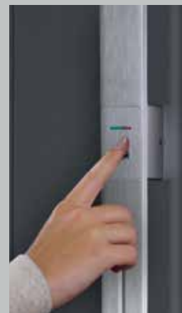
Snímač otisků prstů v madle dveří
