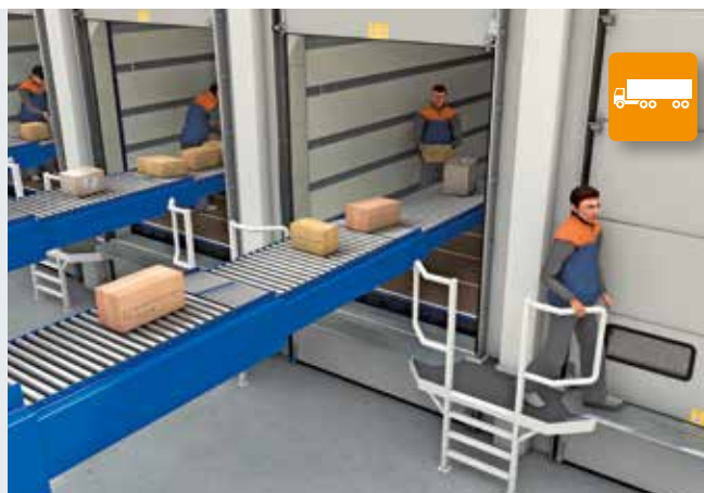
Při nakládce na nákladní vozidla a výměnné můstky zůstává lamelový podstavec s obslužnou lávkou při otevřených vratech na podlaze.
