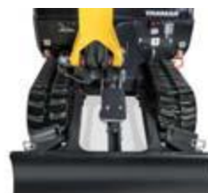
Zúžený podvozek: 980 mm
