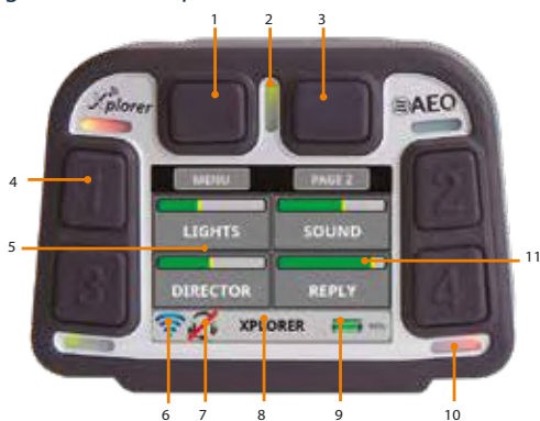
1 Tecla programable. 2 Indicador de estado. 3 Tecla programable. 4 4 teclas de acceso directo programables, o de selección de canal en modo Party-Line. 5 Pantalla TFT de 2.4". 6 Indicador nivel señal Wi-Fi. 7 Indicador mute. 8 Etiqueta nombre del terminal. 9 Indicador nivel batería. 10 4 indicadores LED de modo. 11 Indicador nivel de entrada de cada interlocutor.
