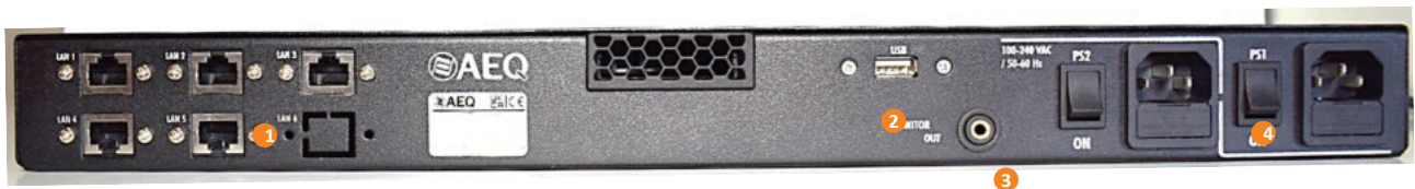
1- 5 puertos de red (LAN1...LAN5) // 2- Puerto USB de mantenimiento // 3- Salida de preescucha // 4- 2 conectores de alimentación AC con interruptores individuales
