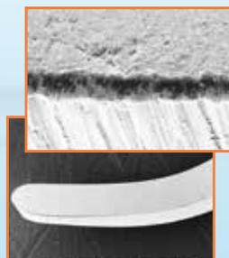
Tranchant de la curette Sharp Diamond et grossissement de l'arête après le test.
