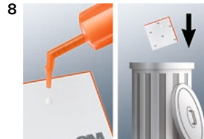
Ne pas exercer de forte pression. Vérifier la position du micro embout mélangeur (image 7) si la force d'extrusion est trop élevée.
