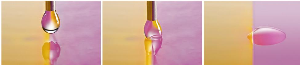
**14. Hydrocompatibilité des matériaux VPS : goutte d'eau appliquée à l'interface de deux matériaux d'empreinte VPS de viscosité fluide non pris 40 secondes après le début du mélange. La goutte d'eau est clairement attirée par le matériau d'empreinte VPS 3M™ Imprint™ 4, le matériau le plus hydrocompatible (à droite).** (Source : données internes de 3M Oral Care. Données disponibles sur demande auprès de 3M Oral Care)
