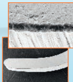
Snijkant van de Sharp Diamond curette en vergroting van de kant na de test.
