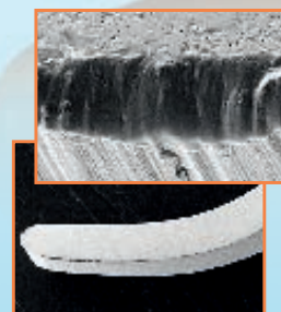
De snijkanten van een typerende niet van een laag voorziene curette en vergroting van de kant na de test.
