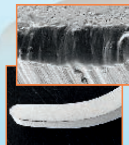
Tranchant d'une curette traditionnelle sans revêtement et grossissement de l'arête après le test.
